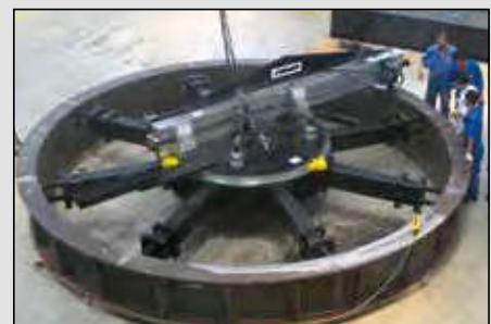
▲ Fresatrici circolari utilizzate nella cantieristica navale e nel settore della produzione di energia elettrica.
