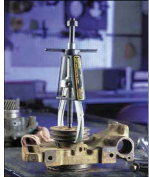
▲ Estrattore EP-204 a 2 ganasce, posizionato in modo da estrarre la puleggia di azionamento di una pompa idraulica.
